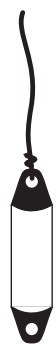
Fendrar där en tamp kan fästas i båda ändar. Eventuellt en stegfender.
